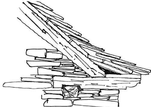
3. Le coyau est un système constructif traditionnel. L'absence d'entrait libère la totalité du volume du fenil, mais les poussées en pied de chevron doivent être reprises par les murs. Cela oblige à positionner la panne sablière à l'intérieur du mur. La rupture de pente du coyau permet alors de couvrir le mur dans son épaisseur et de rejeter plus loin les eaux de pluies. (Schéma CAUE du Tarn)
